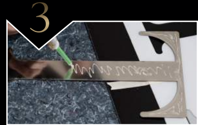
3 Auf einen Buchstaben eine kleine Menge 2-Komponentenkleber auftragen – weniger ist mehr
