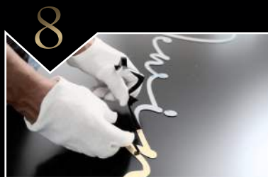
8 Schutzfolien entfernen. Dabei zwingend Handschuhe tragen!
